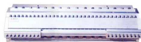
Плоскощелевая головка (фильера) с регулировкой ширины пленки
