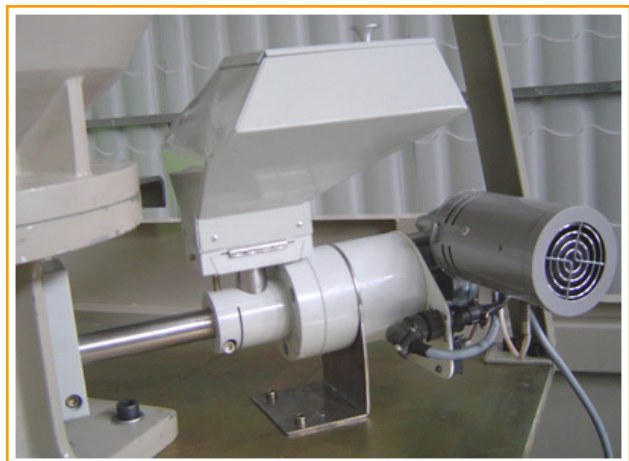
рис.2 Фотография дозатора установленного на термопластавтомат
